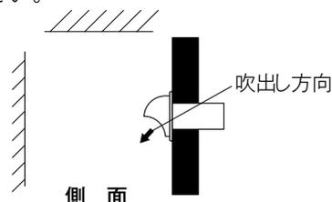
※排湿管の先端には必ず指定のパイプフードを取り付けてください。
