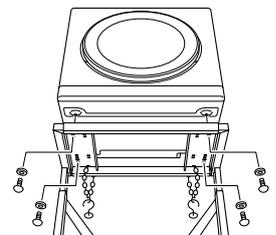
■ 機器停止時に外気の逆流の可能性がある場合はダンパー付排湿口ガイドを使用する
